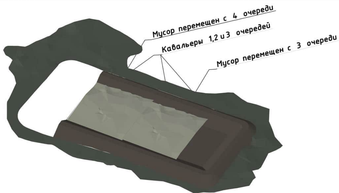
Рисунок 6 - Выемка отходов 4 очереди с накоплением
